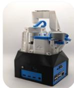
**OpenFlexure Microscope** - Ein preisgünstiges und hochauflösendes Open-Source-Mikroskop, das für Forschungszwecke und Medizin/Diagnostik entwickelt wurde und auf leicht zugängliche Hardware setzt.
